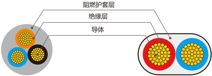
Z(A,B,C)-RVV及60227 IEC 53 (RVV) 结构示意图
